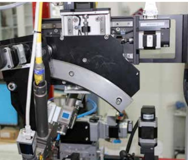
*HepcoMotion ha rappresentato la soluzione più conveniente e affidabile per la realizzazione di un sistema di spostamento su guida circolare di un dispositivo laser*
