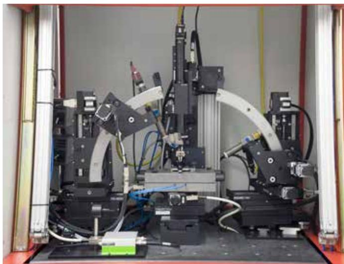
*Il sistema NanoWeld utilizza quattro elementi curvilinei: due segmenti di 90 gradi larghi 44 mm che sporgono sopra la piastra di carico e altri due segmenti di 90 gradi larghi 76 mm sulla base*
