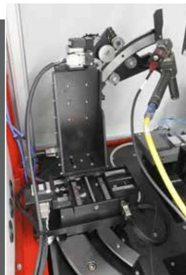
rispondere è stata trovare sul mercato un sistema di controllo in grado di spostare i laser con una tolleranza del 10%", afferma Gunter Hummelt, Direttore Tecnico di Nanosystec. "Per risparmiare spazio e costruire un dispositivo più compatto, abbiamo optato per un sistema basato su un circuito curvilineo piuttosto che utilizzare un sistema con gli assi XY.
